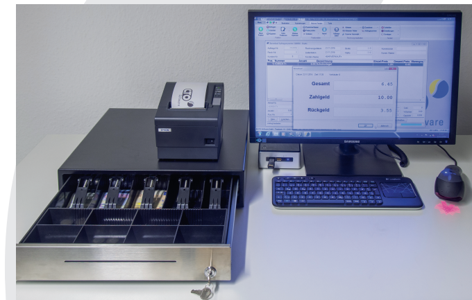
Kassensarbeitsplatz, realisiert mit Mini-PC (links unter dem Monitor), inkl. Kassenschublade, Bondrunder und Barcode-Scanner
